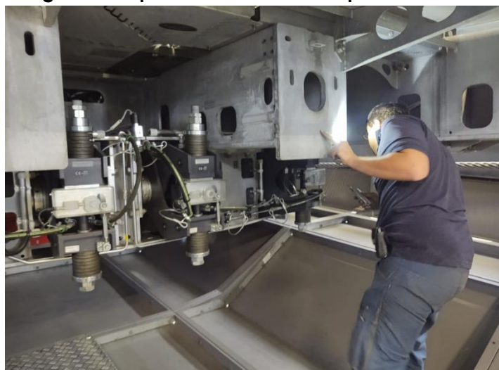
Imagen 23. Inspección de Frenos Después de Pruebas.
