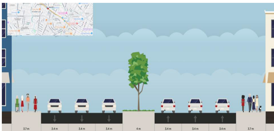
Figura 33. Sección 1 Prolongación de la Reforma.
